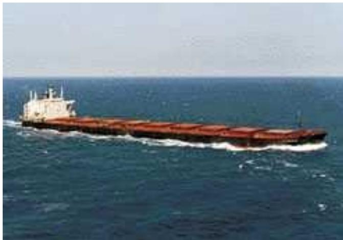
Photo d'un navire vraquier.(9 cales)
