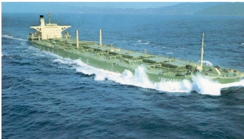
Comme il est possible de le voir sur les photographies ci dessus les pétroliers sont munis de trois mâts principaux, un à l'avant du navire et deux au centre. Le mât situé à l'avant est équipé des feux de route et sert donc à la signalisation du navire alors que les deux mâts centraux sont des mâts pour cornes de manutention des flexibles.
